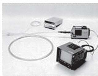
■炉内監視装置
